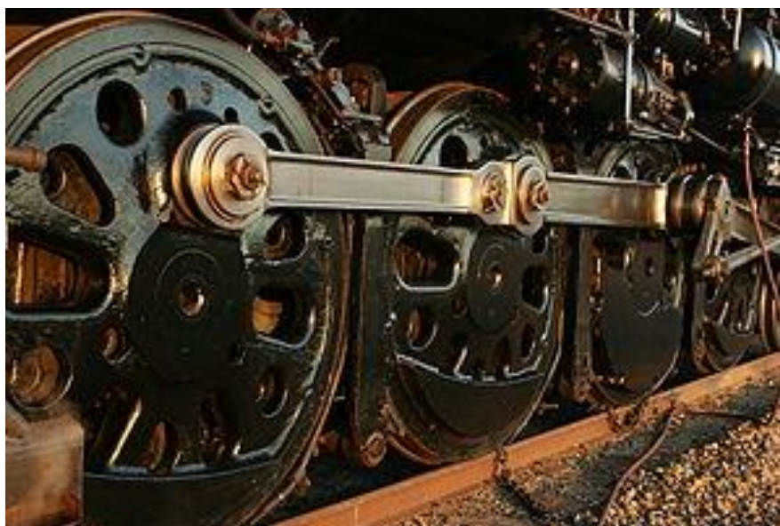
( چرخ‌ها هر کدام به وسیله اهرم های فلزی افقی به یکدیگر وصل شده بود. )
